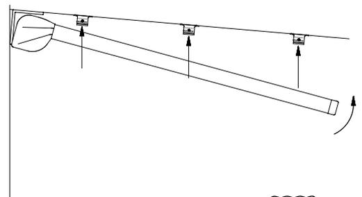
Schrauben Sie die Klemmschrauben (1) mit einem 4 mm Innensechskantschlüssel fest.
