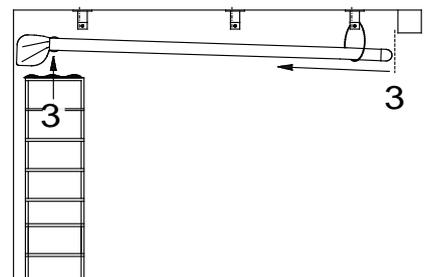
Clipsen Sie die Führungsschienen nach einander in die Schienenhalter ein (4) und ziehen die Klemmschrauben der Schienenhalter fest. Entfernen die Seile wieder.
